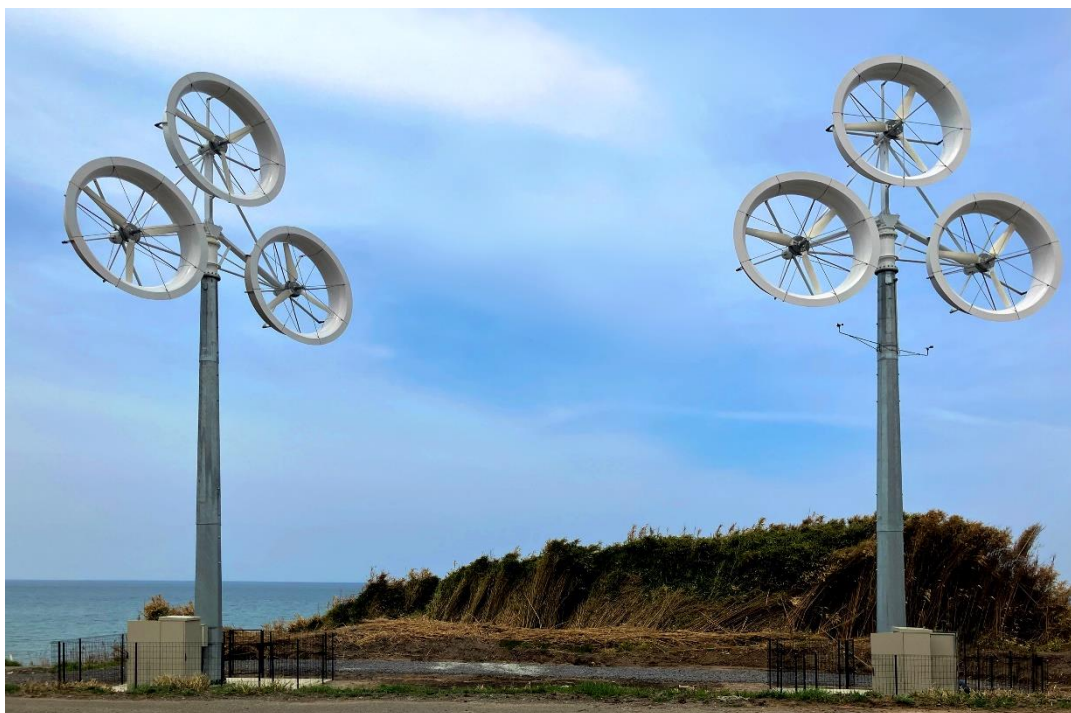
マルチレンズ風車_出力 18kW（9kW×2 基）_秋田県男鹿
